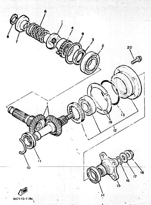
FIG. 20 MIDDLE DRIVE GEAR
