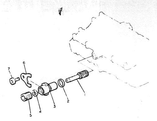
FIG. 21 TACHOMETER GEAR
