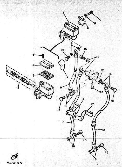
FIG. 37 FRONT MASTER CYLINDER
