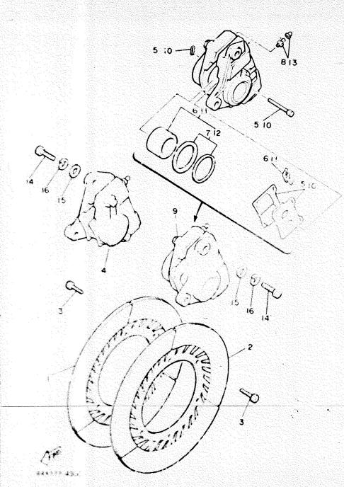
FIG. 30 FRONT BRAKE CALIPER
