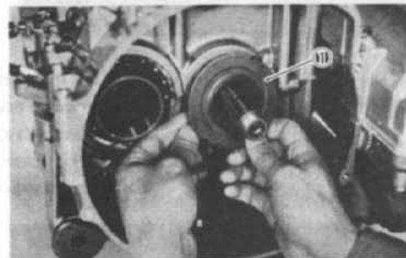
1. Oil pump drive sprocket 1. Pignon d'entraînement de la pompe à huile 1. Antriebskettenrad der Schmierölpumpe
